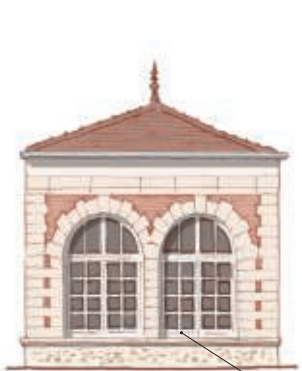
Façade ouest (état d'origine supposé) Echelle 1:100
